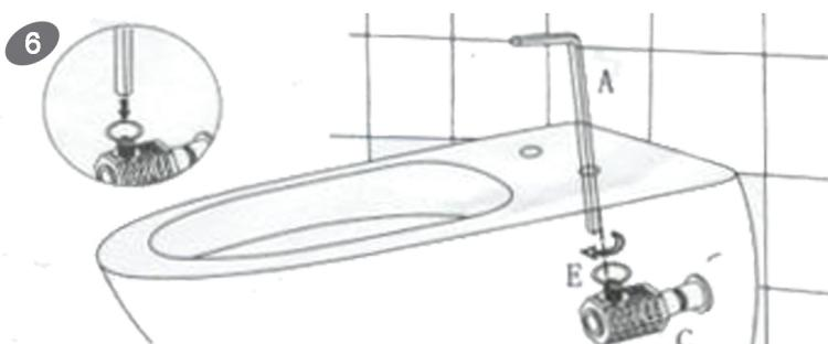
Удостоверьтесь, что унитаз плотно закреплен и не шатается. После выравнивания нанесите силиконовый герметик на месте стыка по всей длине.
